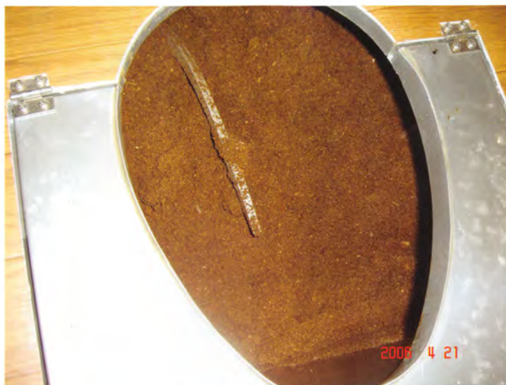
バイオトイレ内のオガクズとスクリュー
