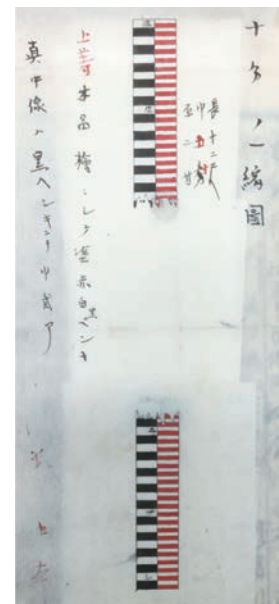
図3 量水標尺木図面
