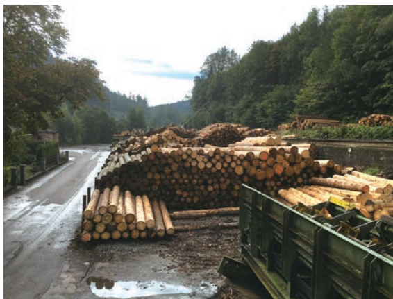
図1. Poschenrieder製材所の原木集積場（撮影：牛尾） 原木は右下に見える機械で樹皮を剥がされ、製材ラインに投入される。
