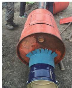
図10 ドラム缶に焚き口となるペール缶を取り付けたところ。つなぎ部分を覆うようにトタンでカバーしたところ。
