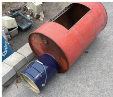
図6 ペール缶をドラム缶に取り付けた形。
