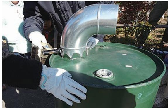
図8 L字型の煙突を取り付けたところ。
