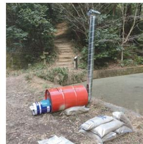
図11 松村式改良型ドラム缶炭窯の全形。
