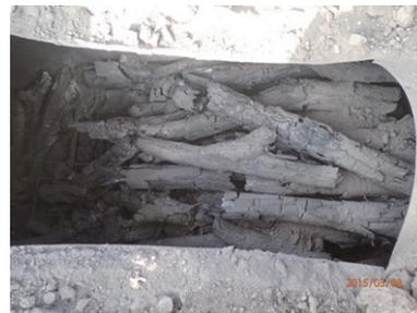
図20 焼き上がった炭：左が焚き口で右が煙突部分。焚き口の材は燃えて灰となっている。
