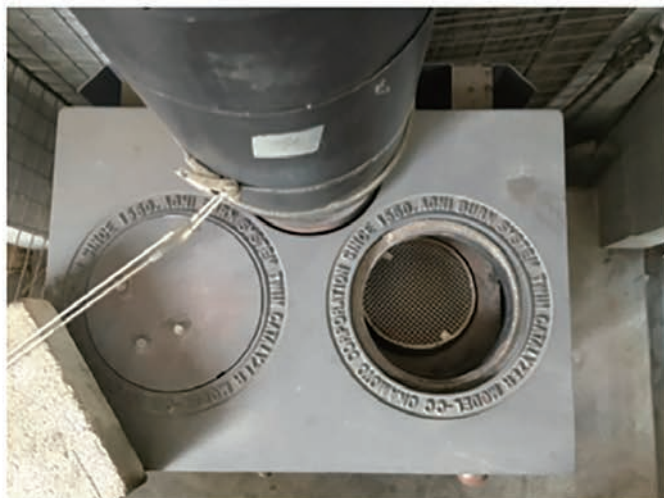
写真1 触媒の設置場所 注) この写真では、写真2の触媒を置いている。
