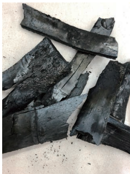
写真9 炭化した竹炭の様子
