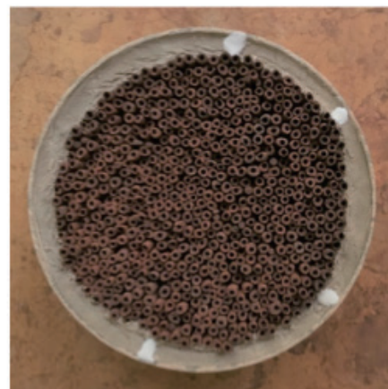
写真7 ハニカムに似た試作触媒 (HC' -2.2-HM )
