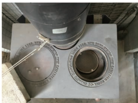
写真2 触媒の設置場所 注) 右側の触媒用の台に、試作触媒等をのせて試験。写真では付属貴金属系触媒をのせている。
