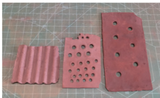
写真16. 触媒粘土から作った波状のものと穴をあけた平板の焼成物。波状のものは、写真10でメッシュを入れずに作成した。
