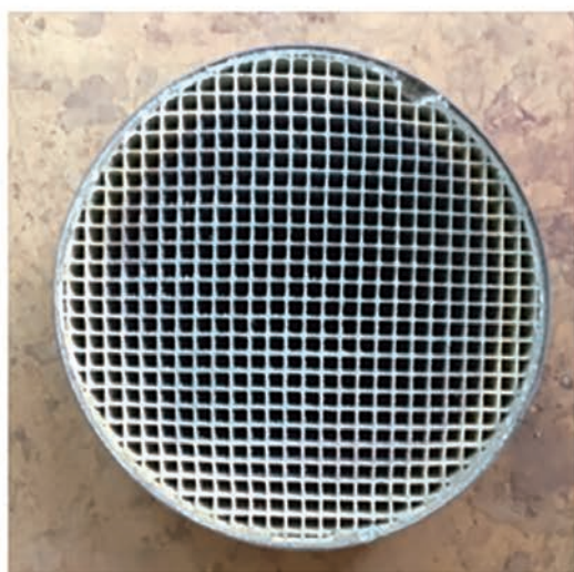
写真2 付属貴金属系触媒 (セラミック製) (HC-AC)
