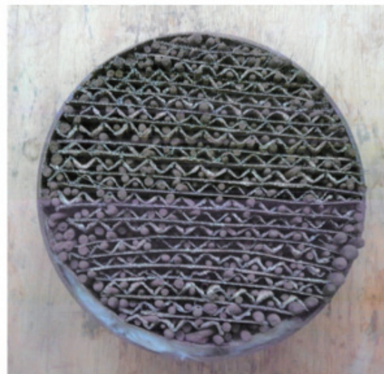
写真11. 写真10でステンレスメッシュにミラクレーを押し込んだのち、表面に触媒粉末を押し込んで成形・焼成した波状のものと平板で段ボール状にした試作触媒。大きな隙間には同様にして作った棒状の焼成触媒を入れている。( HC' -HM )
