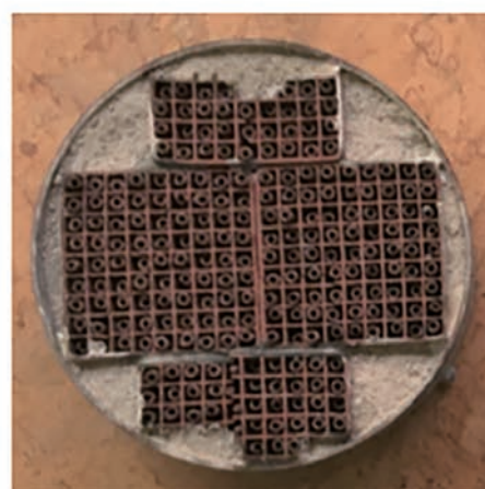
写真14 小型ハニカム3個分のハニカム 中にチューブを入れた触媒 (HC-FA )
