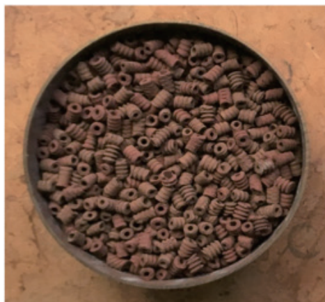
写真6 充填形試作触媒 (FL-2.9-8.9-HM)
