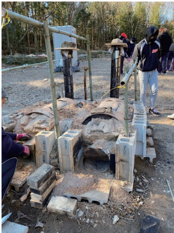
写真5 設置された松村式改良型ドラム缶炭窯
