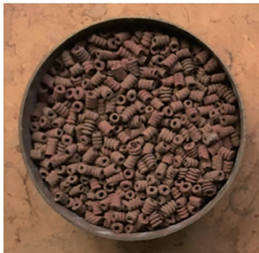
写真6 充填形試作触媒 (FL-2.9-8.9-HM)
