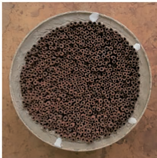
写真8 ハニカムに似た試作触媒 (HC' -2.2-HM )
