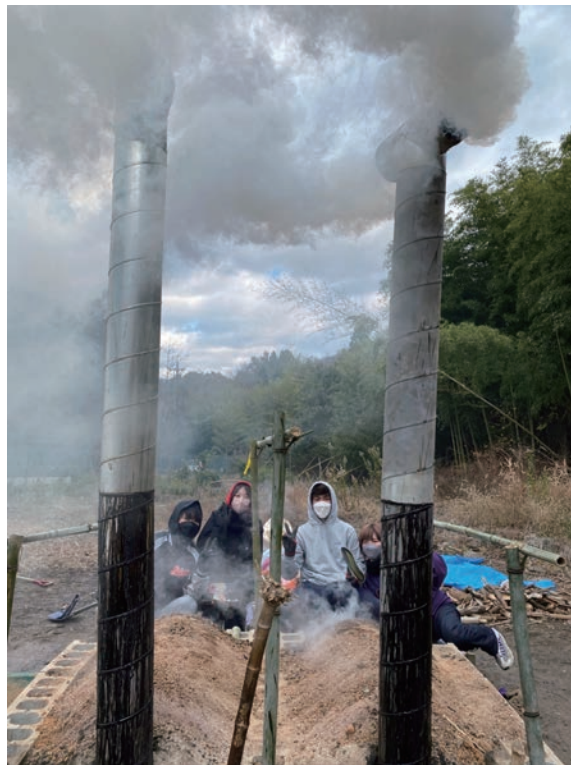
写真6 ドラム缶炭窯で竹炭を焼く学生たち
