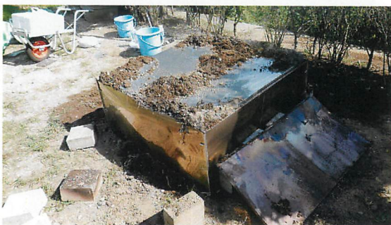
写真2：炭焼き実験中の様子。蓋の隙間に土を被せた。
