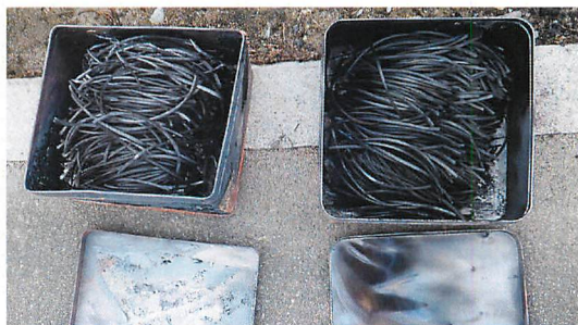
写真6：2回目の炭焼き実験結果。缶に入れた割り箸は完全に 炭化した。
