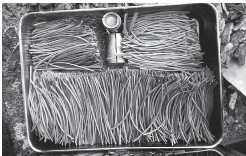
写真6 割り箸の炭化。ステンレス容器中で、ほぼ80%の割り箸が綺麗に炭化されていた。
