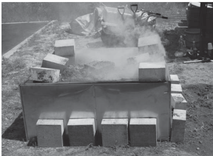
写真3 点火、燃焼中。蓋に重量をかけたことが後に悪影響を与えた。
