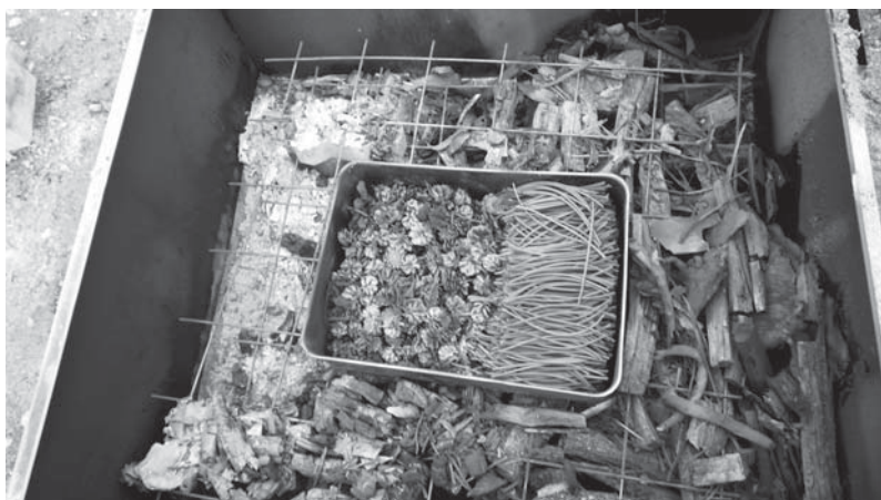
写真7：2回目の炭焼き実験結果：松ぼっくりは炭化した。
