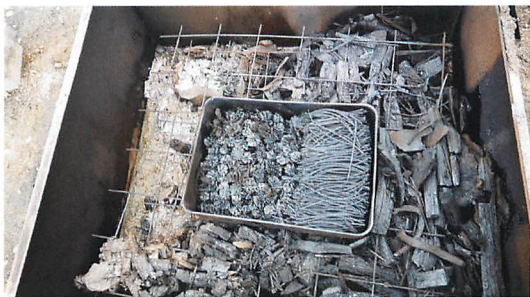
写真7：2回目の炭焼き実験結果：松ぼっくりは炭化した。
