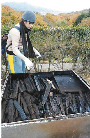
写真5：2回目の炭焼き実験結果。 コナラは完全な炭にはなら なかった。
