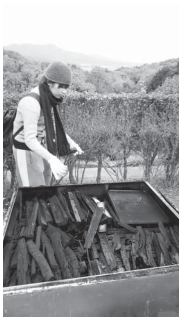
写真5：2回目の炭焼き実験結果。コナラは完全な炭にはならなかった。
