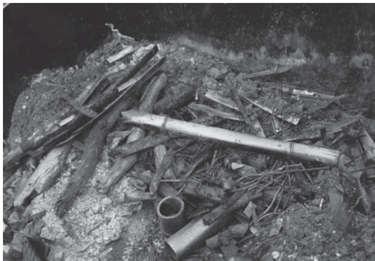
写真5 コナラ材、竹材の炭化。一部に不完全炭化が見られるが、これは当日の時間の制約で早めに消火したためで、次回からの操作にヒントをもらった。
