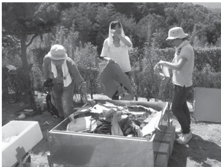
写真1 簡易炭焼き器中への材木、竹材、割り箸、燃料となる包装紙などの挿入。
